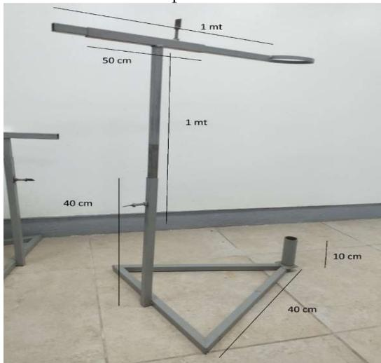
Otra ventaja de la base así diseñada, es que permite aprovechar la estructura del soporte original de la antena parabólica para ajustar la inclinación de la misma y enfocar debidamente la luz solar concentrada sobre el recipiente de cocción.
