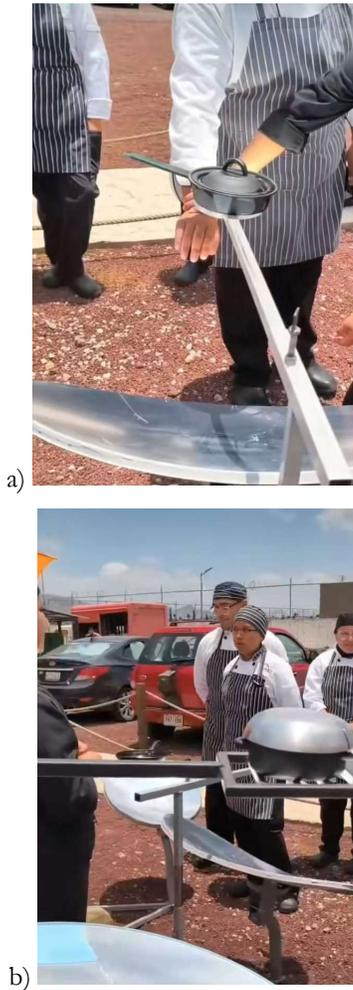
*Demostración de la concentración de la energía solar ubicada en el foco de la antena parabólica*
